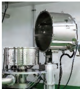
遠心分離設備
